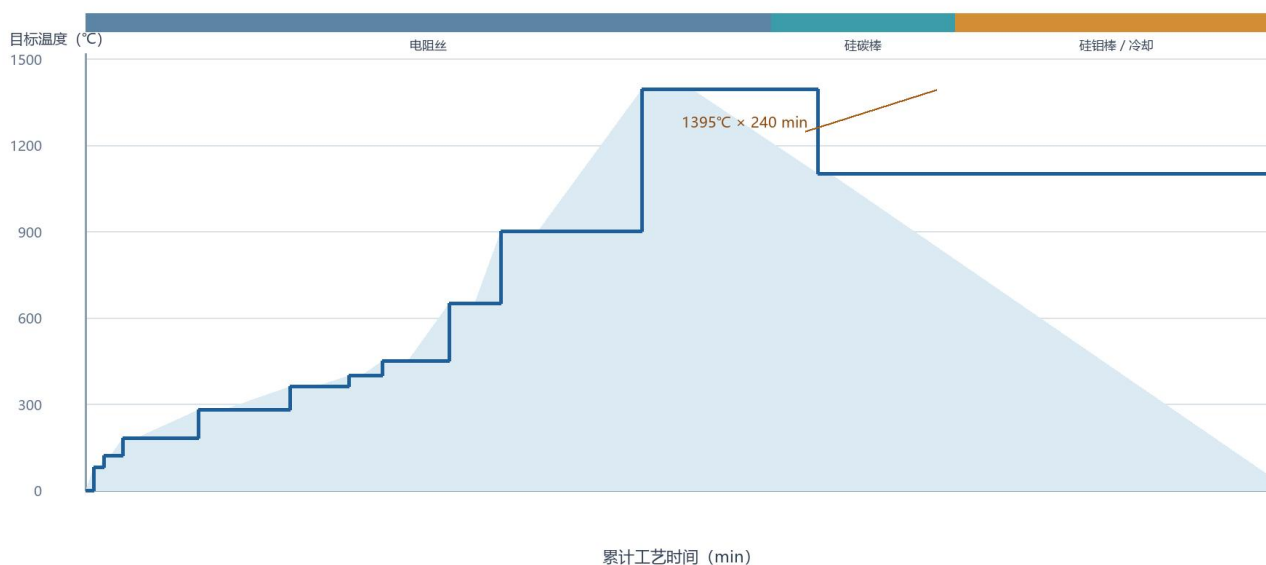
图 2 基于工艺明细整理的 23 段目标温度曲线（总工艺时间约 5700min）
